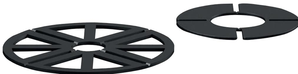
I livellatori possono compensare da 1 a 3 mm di spessore e possono essere posizionati sulle teste dei supporti PR, SE, NM, SB, ST e EH. Realizzati in gomma con effetto antiscivolo e antirumore si differenziano in LGH da 1, 2 e 3 mm con diametro 110 mm e LH3 di 3 mm di spessore con diametro di 150 mm.
