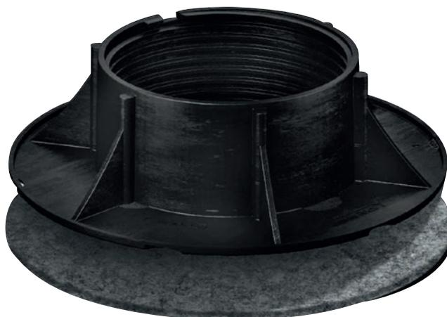
Scudo è uno strato isolante espanso modificato a celle chiuse ad alta densità di 3 mm di spessore. Applicato sotto la base del supporto ha la funzione di strato separatore, protegge il manto impermeabile dai supporti di pavimentazione, inoltre diminuisce il ponte acustico che si crea tra pavimento e piano di posa evitando il ripercuotersi del rumore da calpestio.
