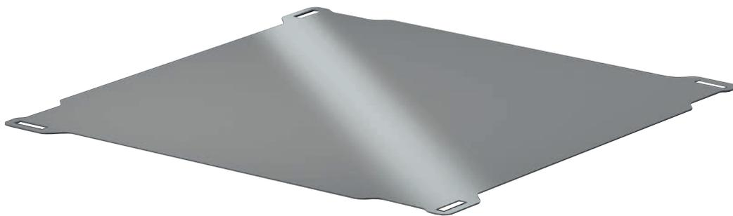
Lo **piastra di sicurezza** di Eterno Ivica è costituita da una lamina di acciaio zincato dello **spessore di 2 mm**, opportunamente sagomata al fine di sostenere gli elementi di pavimentazione in caso di rottura accidentale, annullando i rischi di incidenti in quanto la piastra di sicurezza sosterrà sia l'elemento di pavimentazione che l'eventuale persona.
