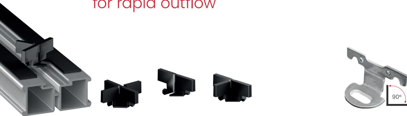
Il Distanziatore è studiato per mantenere i listoni nella corretta posizione e creare la fuga. È utilizzabile nella sua forma originale "a croce" o facilmente adattabile a forma di "T" o di "I", a seconda della geometria delle fughe da realizzare. La clip ha una configurazione che permette l'inserimento in un punto qualsiasi del travetto rimanendo nel suo alloggiamento senza fuoriuscire dalla sede.
