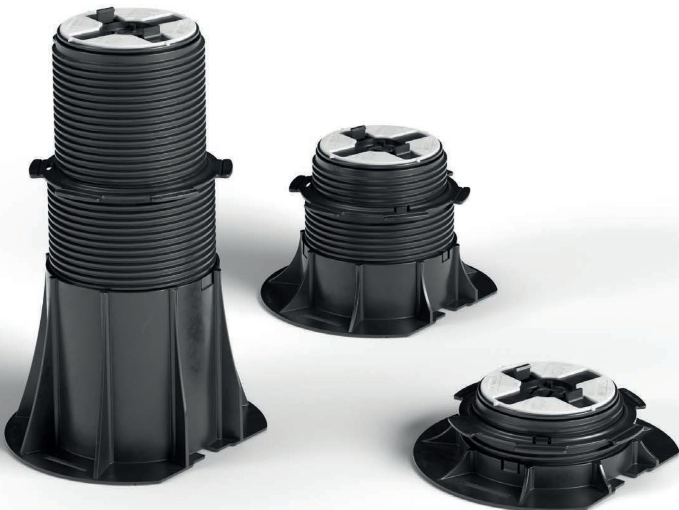
Il supporto regolabile PRIME con testa per travetto in alluminio è la soluzione più flessibile, elegante e sicura mai vista per terrazzi, decking e bordi piscina. Le prestazioni di livellamento della testa basculante, che compensa pendenze del massetto fino al 5%, permette di ottenere una pavimentazione sempre perfettamente piana senza ricorrere ad ulteriori accorgimenti o accessori.
