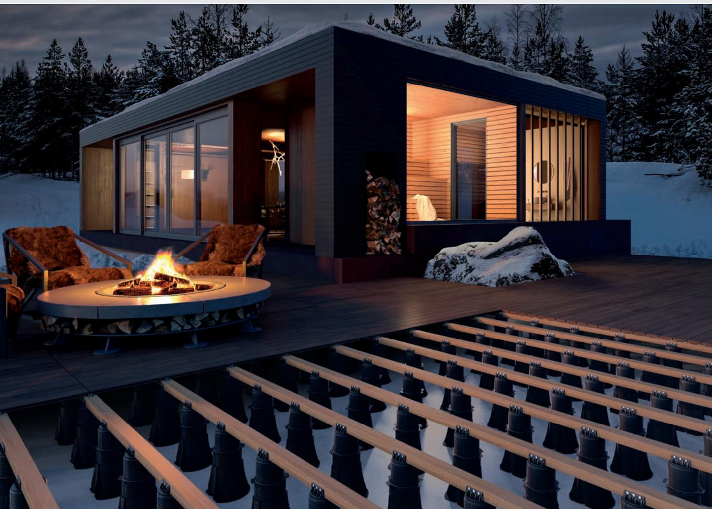
Il supporto regolabile PRIME con testa per travetto in legno è la soluzione più flessibile, elegante e sicura mai vista per terrazzi, decking e bordi piscina. Le prestazioni di livellamento della testa basculante, che compensa pendenze del massetto fino al 5%, permette di ottenere una pavimentazione sempre perfettamente piana senza ricorrere ad ulteriori accorgimenti o accessori.
