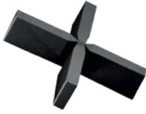
La Crocetta CR è un sistema alternativo al precedente per la posa su fondi sabbiosi, erba o ghiaia. È fornito in due versioni, con altezza mm 15 mm o 20 mm, lo spessore delle alette è di 2-3-4 mm.
